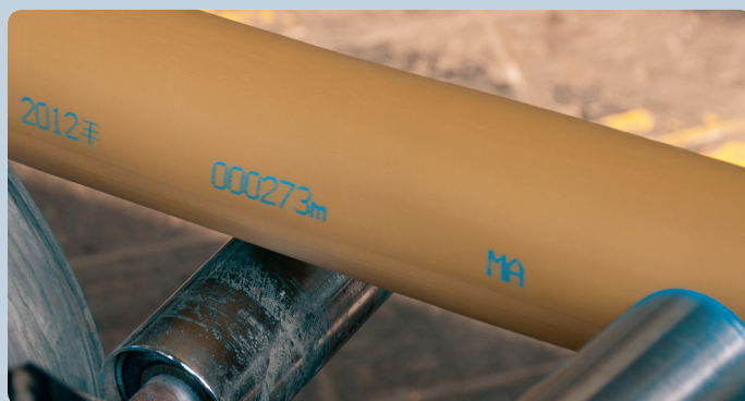
Codifica a getto d'inchiostro a elevato contrasto su un cavo di grosso diametro
